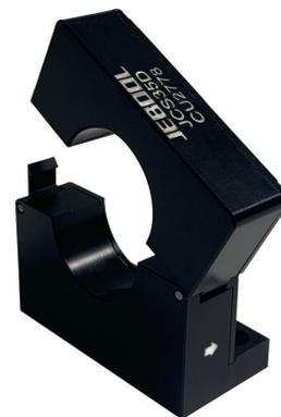
电流传感器 JCS35D 基于霍尔原理，实现对线上电流的高精度测量。独立的供电与测量系统完全隔离，直接输出电压信号与被测电流有较好的线性关系。默认量程 1000A，其他量程可定制，最大 2500A。JCS35D 配有高性能耐磨线缆，线缆长度可以定制。另外，可以根据客户需要，配好 Dallas ID 和接头。
