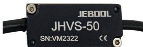
电压传感器 JHVS-50，用于实现对车辆上电瓶电压的测量，低压电气设备碰撞试验过程中实时状态监测等。传感器采用低温漂除法电路，实现信号的输出与电压的输入线性关系，同时满足数据采集设备的信号要求。默认量程±50V，其他量程可定制（小于 100V）。该传感器内部对电源和信号全隔离。传感器拥有可靠的短路保护措施，体积小，精度高。
